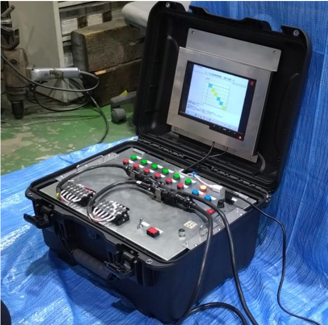
本製品の最大6回線用により検査を行っている様子
