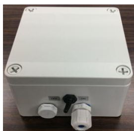
ひずみ監視用子機
